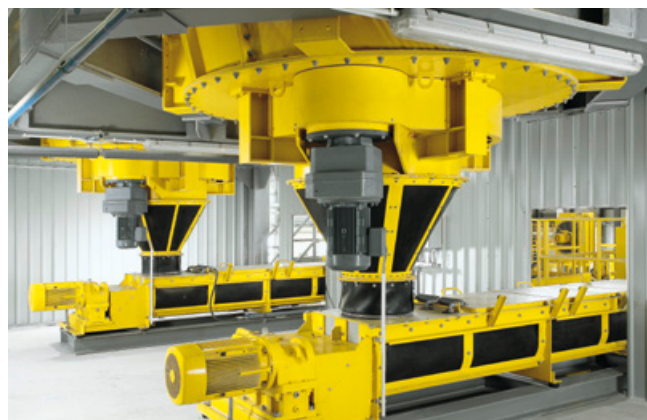
Partie inférieure du réacteur avec mélangeur secondaire à deux arbres
