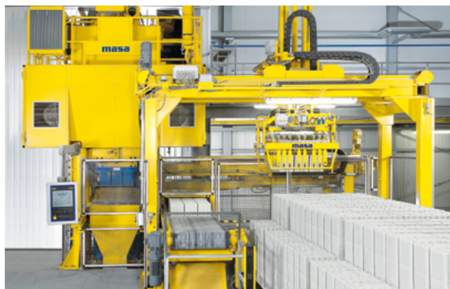
Presse hydraulique pour blocs silico-calcaires avec robot pour déposer les ébauches
