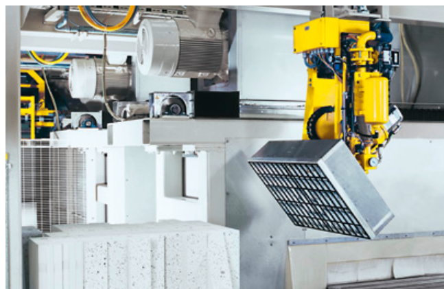
Ventouse à vide brevetée pour le transport de blocs de toutes les dimensions
