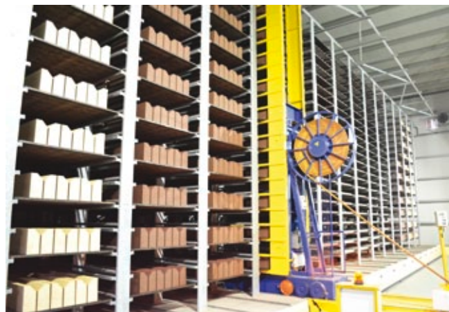
Prêt pour le durcissement: Blocs en béton dans les racks de durcissement
