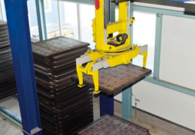
Magasin de palettes de production entièrement automatique Masa
