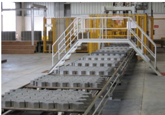
Transport des blocs en béton
