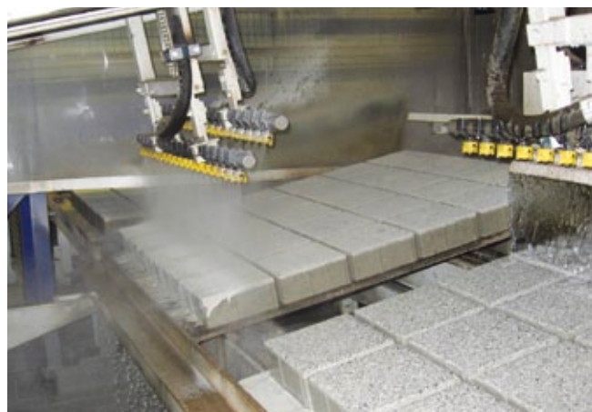
Installation de lavage à 3 stations
