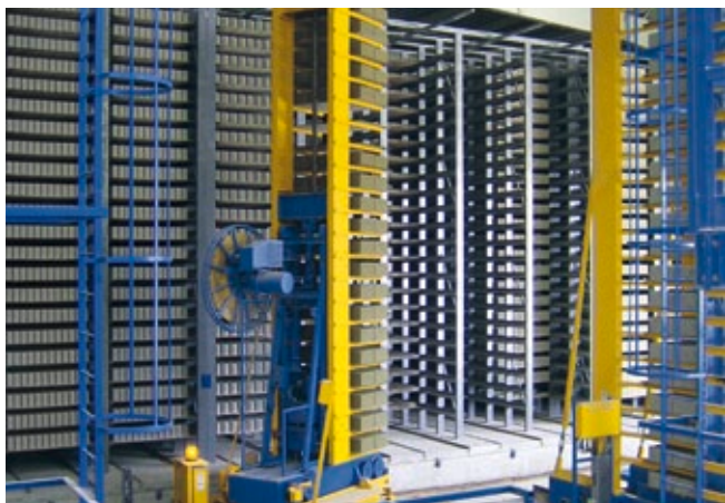
Chargement des racks de durcissement à l'aide d'un chariot à fourche entièrement automatique
